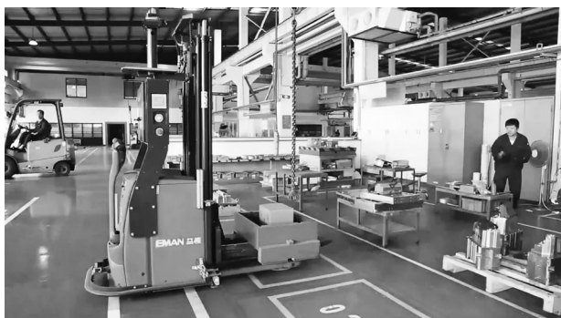
图1 宁波合力车间内的智能搬运机器人
