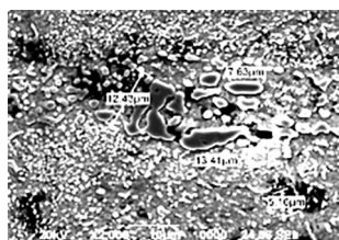
图3 SUS420J2钢中聚集分布的初生碳化物
