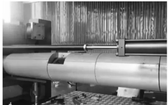
图3 排气式注塑机机筒排气孔示意图
