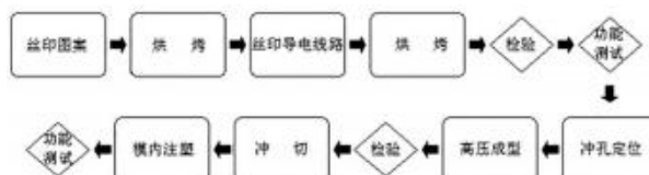
图3 嵌件加工流程示意图
