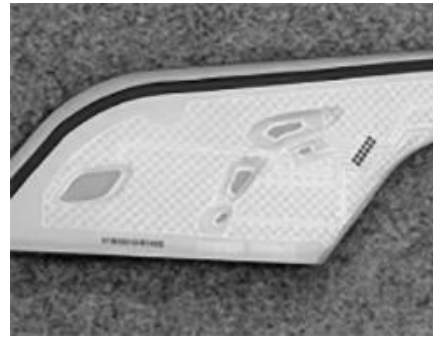
图4 导电银浆做的电路板示意图
