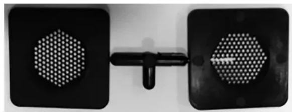
图1. 一出二喇叭状注塑件对比测试:
